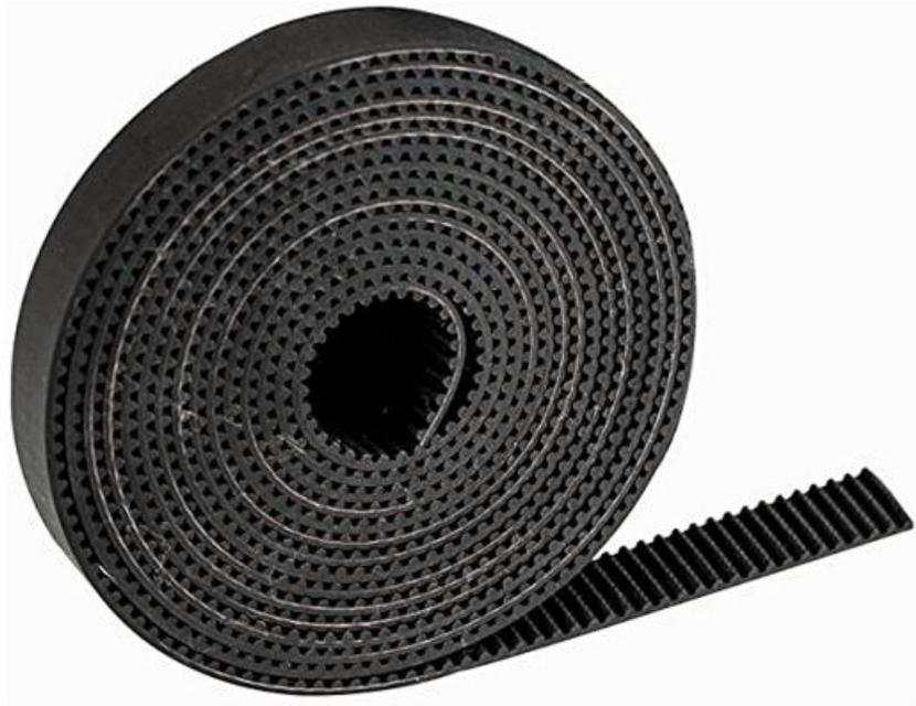
Este sistema es uno de los más usados en impresoras 3d y máquinas hobbistas, su costo es bajo, no requiere mantenimiento y es silencioso. Su principal problema es que no es conveniente usarlo en máquinas grandes y de gran torque ya que tiende a estirarse al ser sometido a cargas medias perdiendo precisión.
