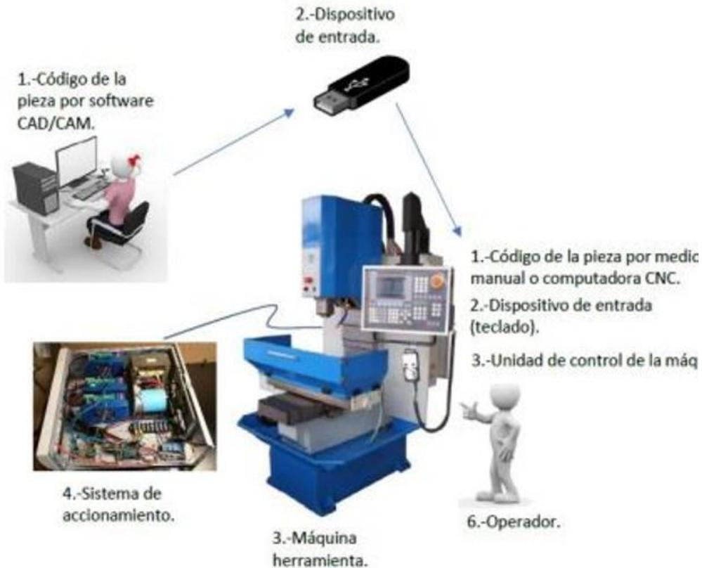
2.-Dispositivo de entrada. Es el mecanismo por medio del cual el código G es introducido en el control de la máquina CNC. Los dispositivos de entrada más utilizados son teclados, unidades de memoria, puertos en serie y redes.
